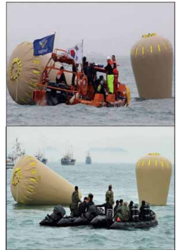
圖 7 空氣浮力球袋 資料來源：《SUBSALVE USA》，〈 http://subsalve.com/portfolio/south-korea-ferry 〉，檢索日期：2021 年 7 月 22 日。
