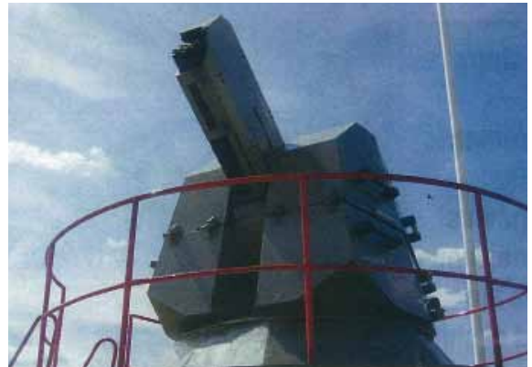
圖3 2009年在聖彼得堡海軍大展中首次展示新銳AK-630雙重奏CIWS系統 主結構為兩座成上下重疊之雙聯快砲組成
