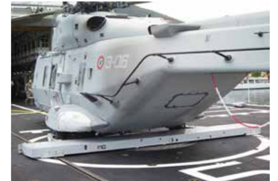
TC-ASIST 系統的捕捉器，可注意捕捉位置為直升機之機輪而非 ASIST 所需之探針。
