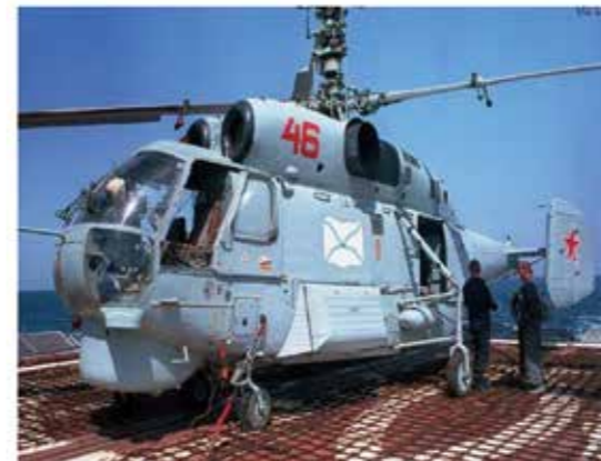
卡 -27 直升機降落於艦艇飛行甲板上，注意機輪下方的輔降網系統
