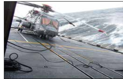
RAST 系統可使直升機惡劣海象下進行落艦與固定作業。 資料來源：參考 Curtiss-Wright, <RECOVERY ASSIST, SECURE AND TRAVERSE SYSTEM (RAST)>, https://www.cw-ems.com/indal/products/helicopter-securing-and-traversing/rast/default.aspx , 檢索日期：2019年5月15日。
