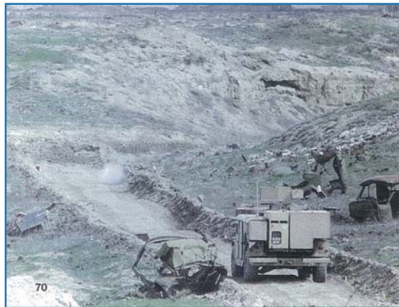
用以引爆土造炸彈 (IED) 及其他「未爆彈」(UXO) 圖16 最先部署於阿富汗及稍後部署於伊拉克之高能雷射系統
