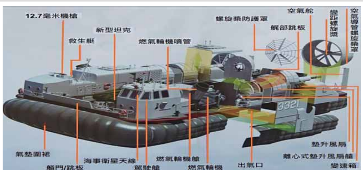
圖九：726氣墊船機件名稱示意圖
