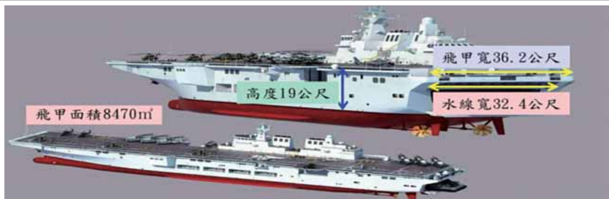
圖七：中共「075型」飛行甲板尺寸與面積
