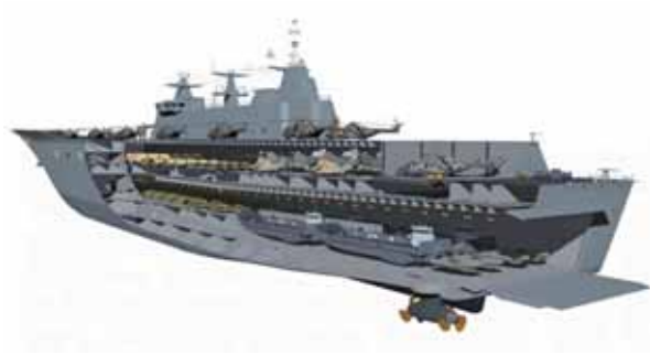
圖三：西班牙胡安·卡洛斯一世號兩棲攻擊艦(左)及剖面圖(右)
