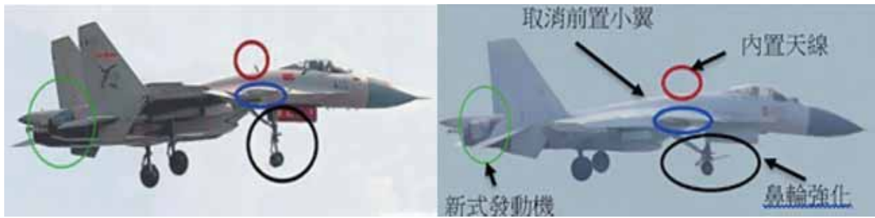
圖八：殲15T型(右)與原型機(左)比較圖
