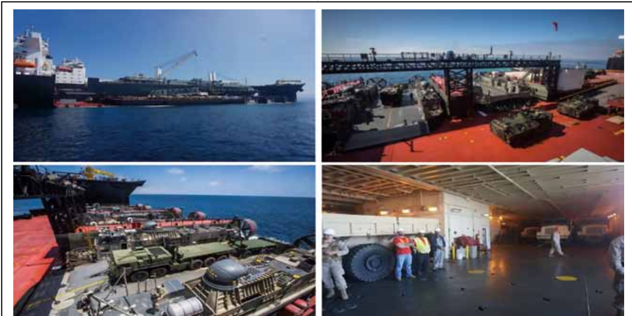
圖六：美軍約翰葛倫號 (John Glenn) 與史塔克漢號 (ATK-Stockham) 對接執行車輛下卸並由氣墊船搶灘運送至目標區海灘
