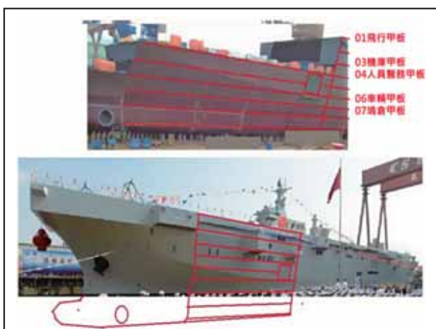
圖五：「075型」兩棲攻擊艦的甲板分配示意圖
