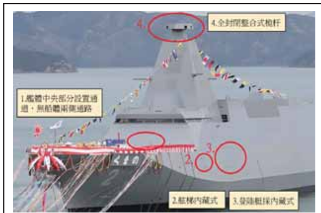
圖四：多功能護衛艦匿踪設計說明圖
