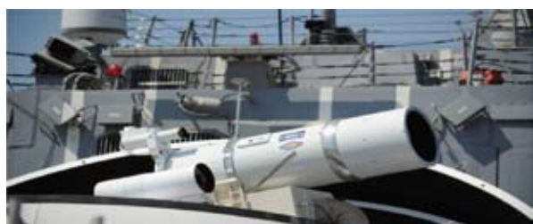
圖五 裝於兩棲登陸艦彭塞號測試用雷射武器
