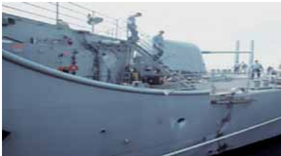
圖八：美軍「普林斯頓」號遭沉底雷爆炸震波造成艦身受損
