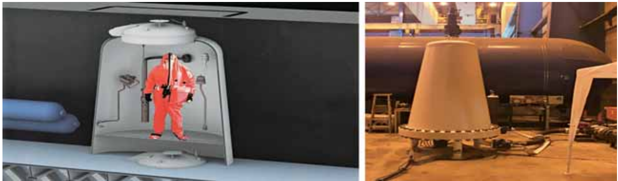
圖四：潛艦加壓逃生塔系統
