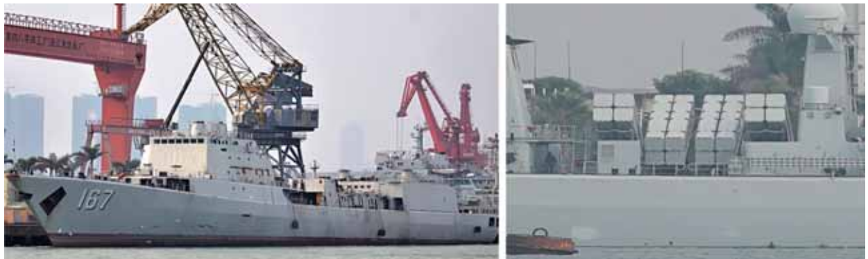
圖七：改裝中的「深圳號」（圖左）與完成換裝的「鷹擊12A」（圖右）
