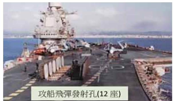
圖五：瓦良格號航艦艦艙飛彈發射孔示意圖
