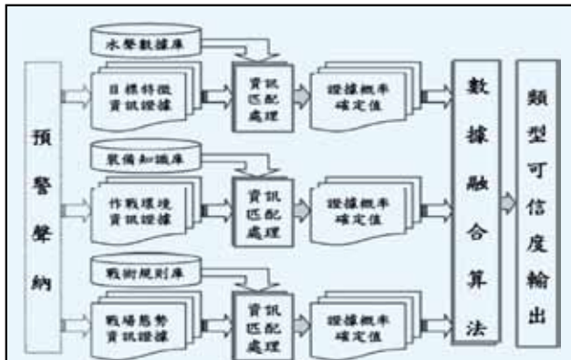
圖六 來襲魚雷目標識別處理流程
