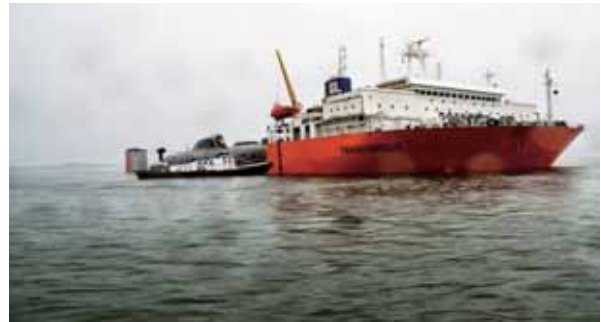
圖七：荷蘭「Transshelf號」半潛船運載俄羅斯2艘核子動力潛艇
