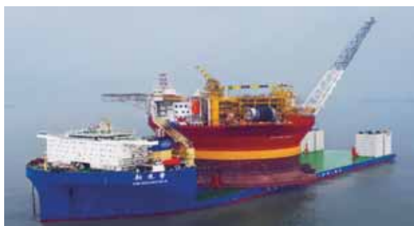
圖六：新光華號運載鑽油平台
