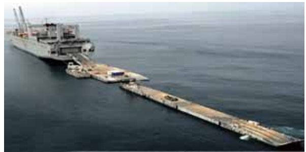
圖十二：登陸部隊藉由浮箱、浮橋實施登陸、卸載
