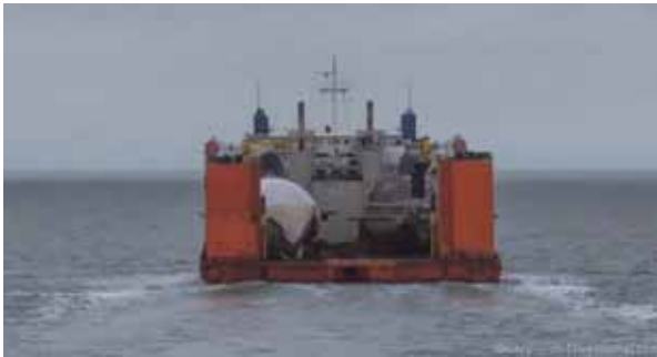
圖七：荷蘭「Transshelf號」半潛船運載俄羅斯2艘核子動力潛艇
