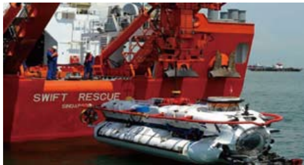
圖八 DSAR-6於後甲板進行吊放作業
