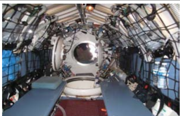
圖六 SRV內部減壓設備
