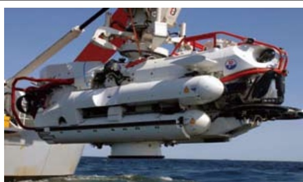
圖四 北約「潛艦救援載具」(SRV)執行水面吊放作業
