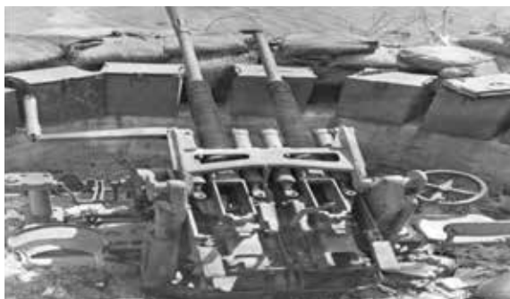
圖 21 與鎮海樓配置相同的「九六式 25 毫米雙聯裝防空機砲」 資料來源：維基分享資源，〈九六式 25 毫米防空機砲〉，網址： https://zh.wikipedia.org/wiki/%E4%B9%9D%E5%85%AD%E5%B3%8F25%E6%AF%AB%E7%B1%B3%E9%AB%98%E5%B0%84%E6%A9%9F%E7%82%AE 檢索日期：西元 2021 年 5 月 11 日
